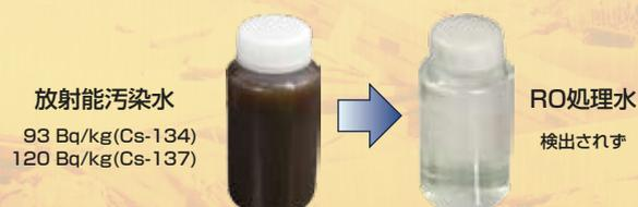
放射性セシウムが含まれる放射能汚染水を、弊社RO(逆浸透膜)純水装置にて処理。
